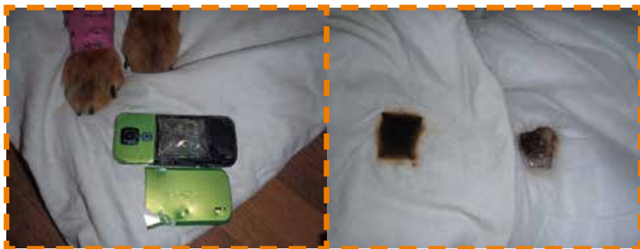
Baterie mobilního telefonu rozkousaná psem a následně prohoření peřechu po rozkousání (včas uhašeno majiteli psa, dříve než se požár rozvinul)
