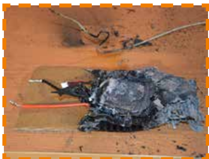
Požár akumulátoru při nesprávném nabíjení
