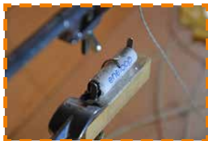
Zkrat baterie – propojení kontaktů kovovým plíškem (došlo k vytečení toxického elektrolytu)
